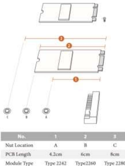
2- Remova a porca e reposicione para o Type correspondente ao SSD a ser instalado.
